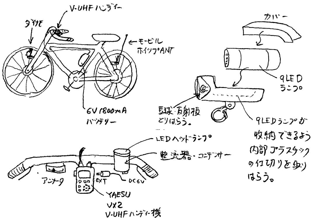
100円 shopで“自転車用ヘッドランプユニット”を購入し、9LEDランプとタイオート・コンデンサーを組み込み。
